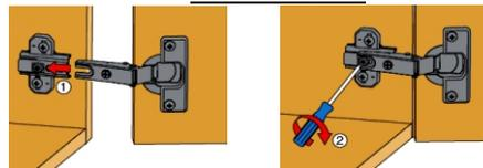
По завершении регулировки глубины двери затягивается винт.
