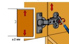
Слегка ослабить крепежные винты монтажной планки, выверить по высоте позицию двери. Затем крепежные винты снова затянуть.
