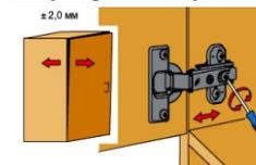
Ослабить крепежный винт и отрегулировать расстояние между дверью и боковиной шкафа. Затем снова затянуть крепежный винт.
