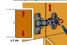
Слегка ослабить крепежные винты монтажной планки, выверить по высоте позицию двери. Затем крепежные винты снова затянуть.
