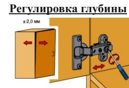
Ослабить крепежный винт и отрегулировать расстояние между дверью и боковой шкафом.
