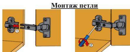
По завершении регулировки глубины двери затягивается винт.
