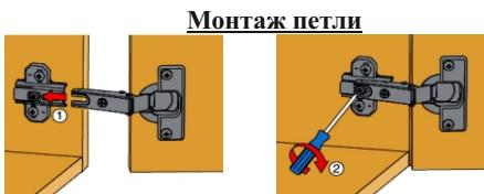
По завершении регулировки глубины двери затягивается винт.
