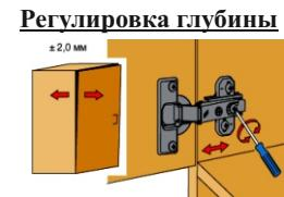
Ослабить крепежный винт и отрегулировать расстояние между дверью и боковойной шкафом.
