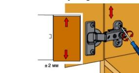
Слегка ослабить крепежные винты монтажной планки, вывернуть по высоте позицию двери.
