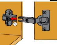
Боковая часть петли шлицем вводится под предварительно смонтированный винт монтажной планки и здвигается от себя.
