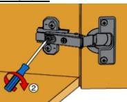
По завершении регулировки глубины двери затягивается винт.
