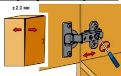
Ослабить крепежный винт и отрегулировать расстояние между дверью и боковой шкафом.
