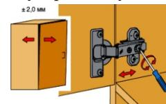
Ослабить крепежный винт и отрегулировать
