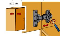
Ослабить крепежный винт и отрегулировать расстояние между дверью и боковиной шкафа. Затем снова затянуть крепежный винт.
