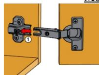
Боковая часть петли шлицем вводится под предварительно смонтированный винт монтажной планки и задвигается от себя.
