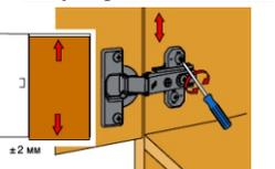
Слегка ослабить крепежные винты монтажной планки, выверить по высоте позицию двери. Затем крепежные винты снова затянуть.
