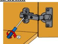
По завершении регулировки глубины двери затягивается винт.
