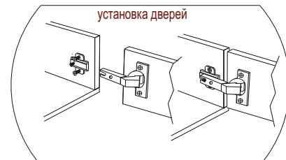
Гвозди 2\*25 используются для крепления ДВП и дна ящика, саморезами 3,5\*16 крепятся петли и направляющие ящиков, шурупами 3\*25-навесы. Стяжка 15 мм используется для установки штангодержателей.
