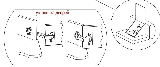
Гвозди 2\*25 используются для крепления ДВП и дна ящика, саморезами 3,5\*16 крепятся петли и направляющие ящиков, шурупами 3\*25-навесы. Стяжка 15 мм используется для установки штангодержателей.
