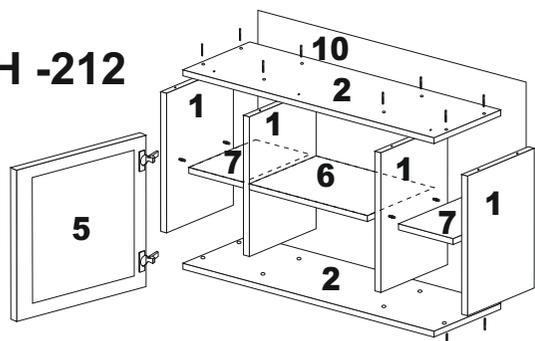
Гвозди 2\*25 используются для крепления ДВП, саморезами 4\*16 крепятся петли. Если несколько модулей устанавливаются рядом, их необходимо стянуть между собой межсекционными стяжками 25 мм, просверлив самостоятельно отверстия диаметром 5 мм в произвольных местах.
