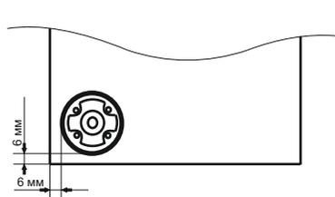
Гвозди 2\*25 используются для крепления ДВП, саморезами 4\*16 крепятся петли. Если несколько модулей устанавливаются рядом, их необходимо стянуть между собой межсекционными стяжками 25 мм, просверлив самостоятельно отверстия диаметром 5 мм в произвольных местах. К верхней крышке приворачивается уголок, сверлом 8 мм просверливается отверстие через уголок в задней стенке шкафа, в стене на глубину 60 мм. Через прижимную планку шурупом-дюбелем секция крепится к стене, уголок закрывается заглушкой.
