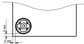
Гвозди 2\*25 используются для крепления ДВП, саморезами 4\*16 крепятся петли. . Если несколько модулей устанавливаются рядом, их необходимо стянуть между собой межсекционными стяжками 25 мм, просверлив самостоятельно отверстия диаметром 5 мм в произвольных местах. К верхней крышке приворачивается уголок, сверлом 8 мм просверливается отверстие через уголок в задней стенке шкафа, в стене на глубину 60 мм. Через прижимную планку шурупом-дюбелем секция крепится к стене, уголок закрывается заглушкой.
