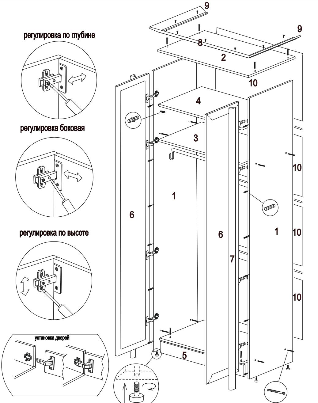
Гвозди 2\*25 используются для крепления ДВП, саморезами 4\*16 крепятся петли. Если несколько модулей устанавливаются рядом, их необходимо стянуть между собой межсекционными стяжками 25 мм, просверлив самостоятельно отверстия диаметром 5 мм в произвольных местах.
