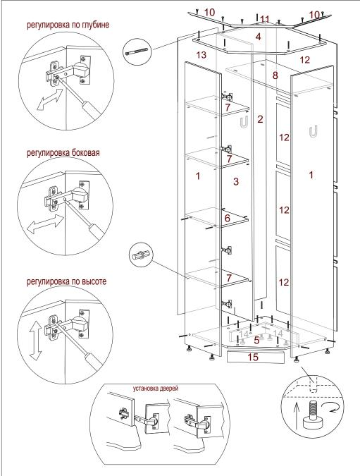
Гвозди 2\*25 используются для крепления ДВП, саморезами 3,5\*16 крепятся петли. Если несколько модулей устанавливаются рядом, их необходимо стянуть между собой межсекционными стяжками 25 мм, просверлив самостоятельно отверстия диаметром 5 мм в произвольных местах.
