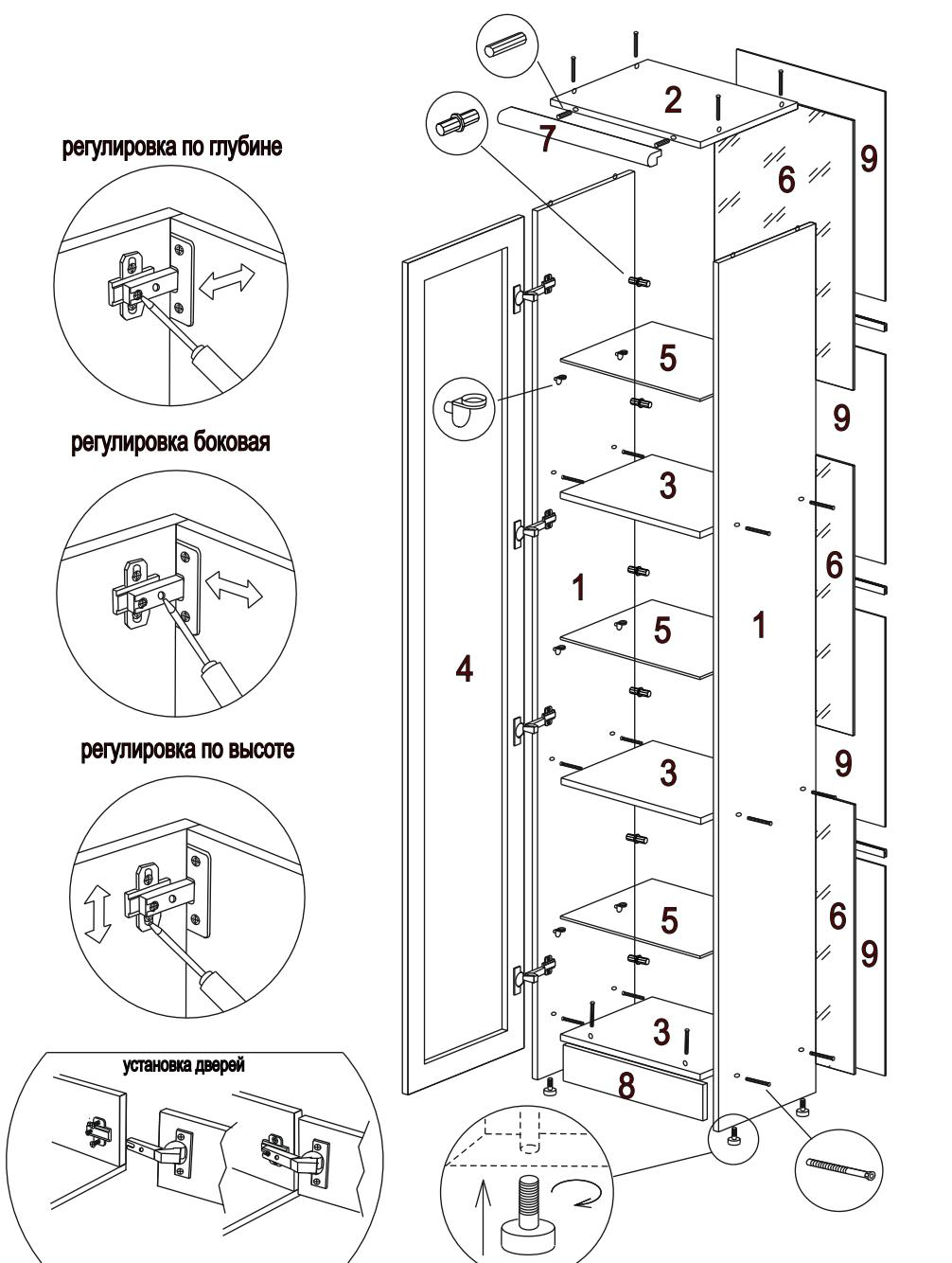
Гвозди 2\*25 используются для крепления ДВП, саморезами 4\*16 крепятся петли. Если несколько модулей устанавливаются рядом, их необходимо стянуть между собой межсекционными стяжками 25 мм, просверлив самостоятельно отверстия диаметром 5 мм в произвольных местах.
